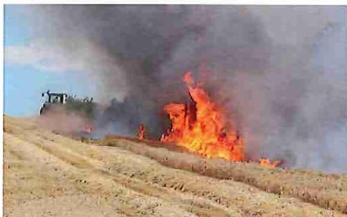
Un feu de récolte est généralement provoqué par des étincelles provenant de chocs de la machine contre des matériaux solides (pierres, fer) ou à un mauvais entretien des machines (filtres encrassés, pots d'échappement défectueux...).
